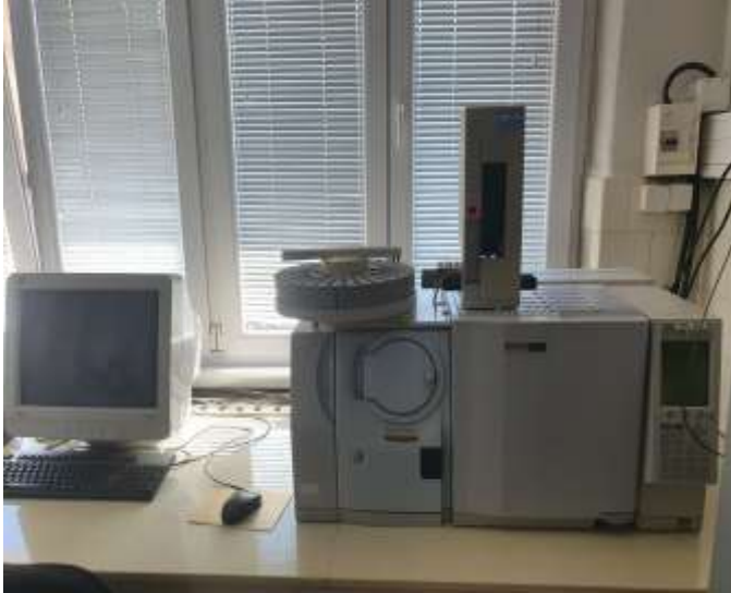
Slika 3. Plinski kromatograf s masenim spektrofotometrom (GC/MS)
